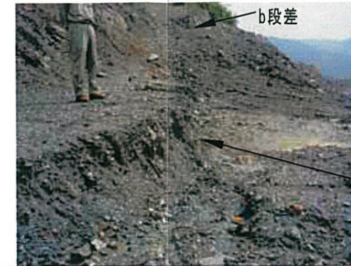
写真③：6月初旬 2次すべり頭部付近 a段差は70cm程度 b段差は小段ごと落ちる
